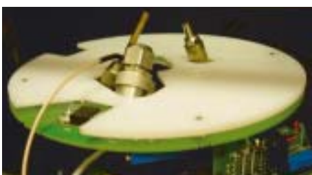
Detailansicht des Lötkopfes mit Dispenser und Pyrometer
